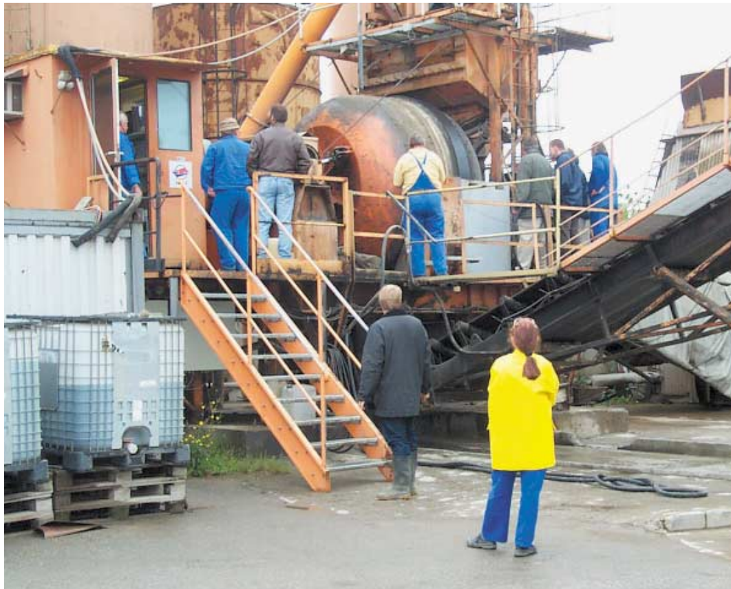
Mischanlage „Liebenthal“ an der A 24 bei Wittstock – Mischung zum Trisoplast
